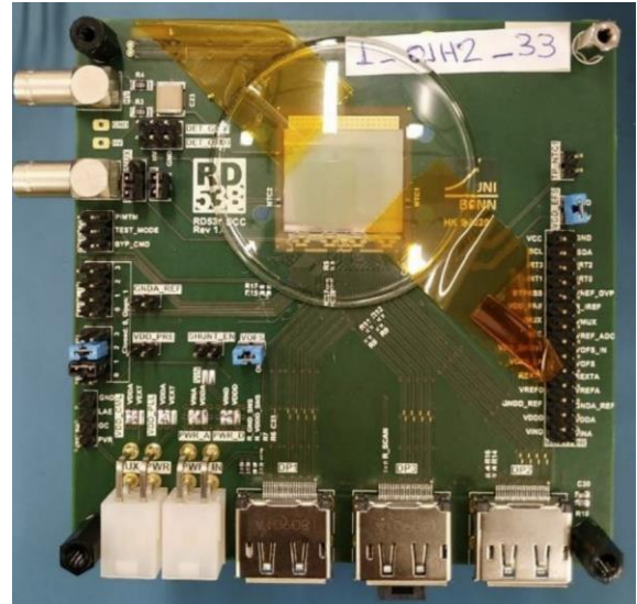
1 pav. Testavimui naudota vienalustė korta su RD53B CMS lustu
